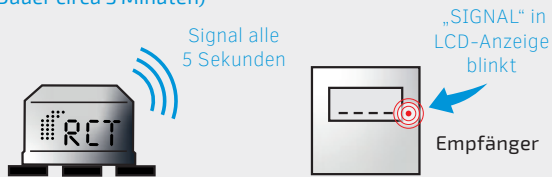
Abb. 4b | Senden, Signal am Empfangsort testen und Empfänger platzieren
