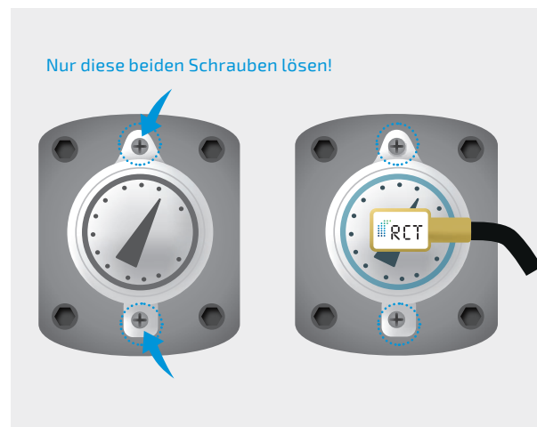
Abb. 2+3 | Original Anzeigeuhr entfernen und RCT-Sensor einsetzen
